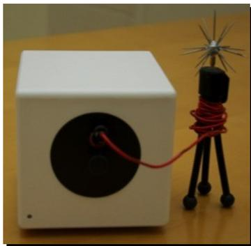
3. Присоедините конец сенсора «Спутник» к Вставке с металлическим цилиндром.
